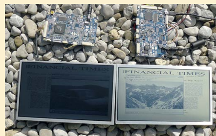
Bild 2: Vergleich zweier 10,1"-Bildschirme mit 1024 x 600 Bildpunkten bei direkter Sonneneinstrahlung: Links ein herkömmliches TFT-LCD, rechts das Display PQ 3Qi-01 von Pixel Qi
